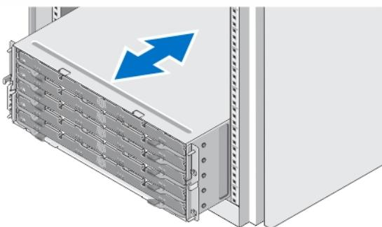
**Αριθμός 1. Εγκατάσταση του συστήματος σε rack**
